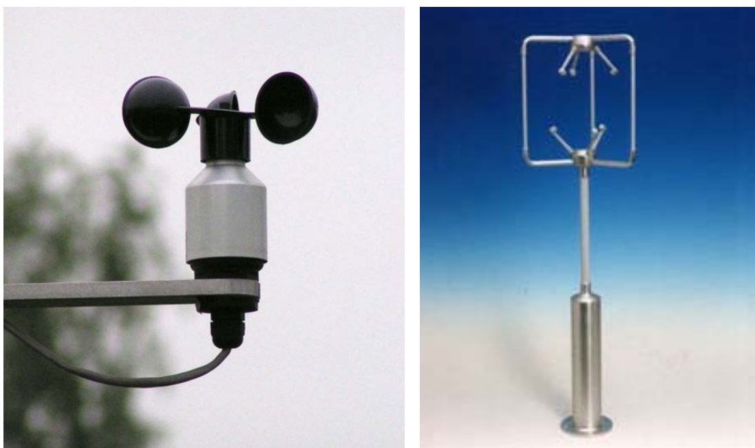
Rys.1 Anemometr rotacyjny oraz ultradźwiękowy
